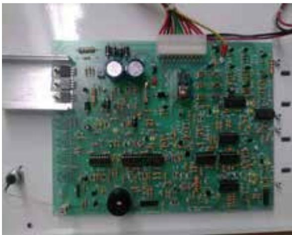
شکل ۱-۲۹ مدار الکترونیکی یک نمونه تابلو اعلام حریق
